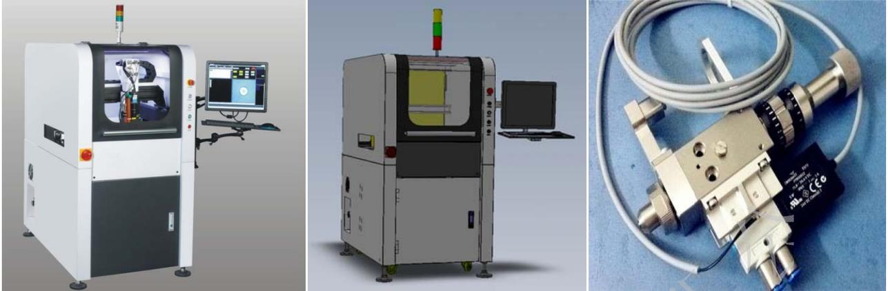
在线式喷射点胶机可实现高速度、高精度、高重复性的点胶作业，适用于底部填充、腔体填充、晶圆粘贴、零件涂覆保护、贴合密封等，特别适用于大批量的生产加工，广泛应用于半导体封装和组装生产过程中的多种胶水材料应用场合。
